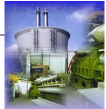
Gázmotor 5,4MWe/5,8 MWt 9,8 MWt hulladékhő
